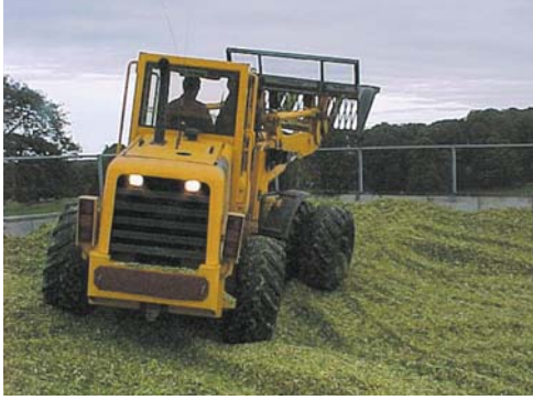
شكل رقم (19) رص العشب بعد تعبئة السايلاج
